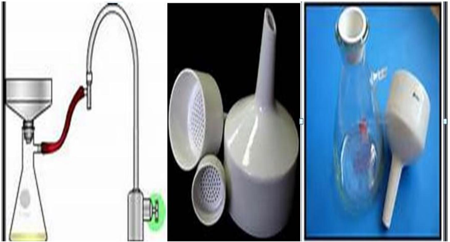
شكل (1) قمع بخنر متصل بمضخة التفريغ
