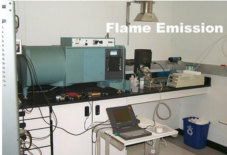
شكل (2): مطياف الانبعاث عن طريق اللهب Flame emission spectrometer
